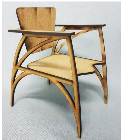
Figura 1. Mock-up em mdf 3mm na escala 1:5. Da autora.
