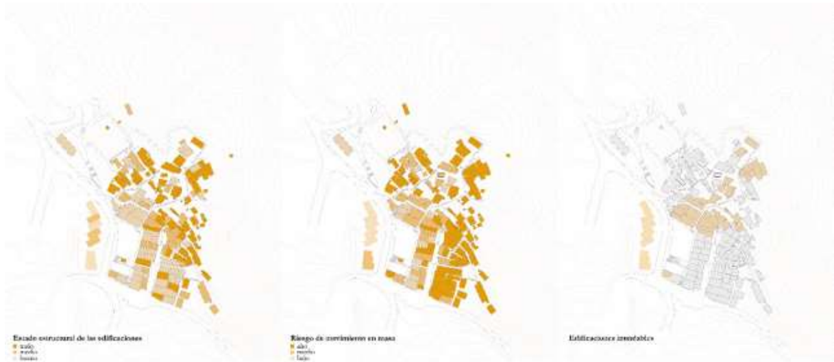
Figura 2. Estado estructural de las edificaciones, riesgo de movimiento en masa y edificaciones inundables. Fuente: Empresa de Desarrollo Urbano et al., Informe de amenaza, vulnerabilidad y riesgo por movimientos en masa inundaciones y avenidas torrenciales. Polígono Pinares de Oriente , (Medellín: Empresa de Desarrollo Urbano, 2016).
